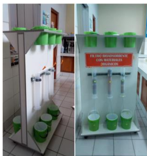
Figura 2: Sistema de adsorción - Filtro bioadsorbente.
